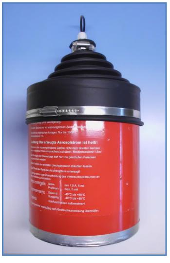
Wichtig: Vor der Endmontage der Gummischutzabdeckung muss, nach dem Anschluss des Züpi-Steckers an den Löschgenerator, eine Kabelschlaufe von ca. 20 cm in den Raum zwischen der Gummischutzabdeckung und Löschgenerator gelegt werden, damit es zu keiner Beschädigung des Züpi-Steckers während dem Betrieb und während der Demontage kommen kann!
